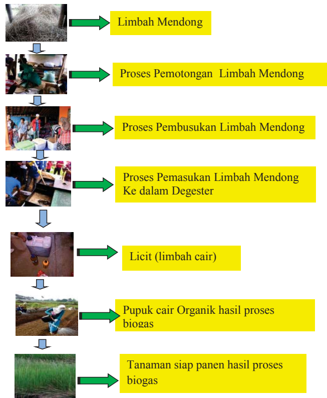
Gambar 2 Rancangan proses produksi pupuk organik cair dari biogas limbah mendong
